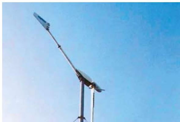
{ FIG. A5.2 } Micro-turbina eólica.
