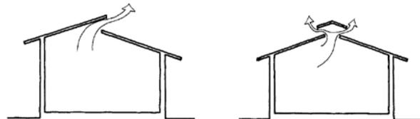
{ FIG. 1.71 } Dois recursos para forçar a movimentação do ar, através de abertura nos tectos.
