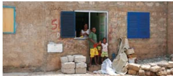
{ FIG. 1.80 } A construção tradicional e popular em Cabo Verde envolve o uso de materiais maciços, que conferem inércia térmica aos edifícios. Este tipo de construção é adequado a climas como o de Cabo Verde, quente e seco, com amplitudes térmicas significativas entre o dia e a noite.
