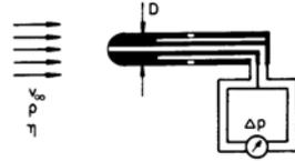
$$D = 6 \cdot 10^{-3} \text{ m} \quad \Delta p = 125 \frac{\text{N}}{\text{m}^2}$$
