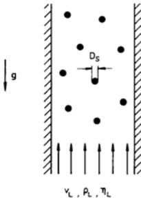
$$D_s = 5 \cdot 10^{-5} \text{ m} \quad \rho_s = 2.5 \cdot 10^3 \frac{\text{kg}}{\text{m}^3}$$
