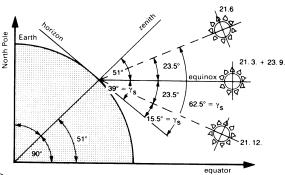
6 Degree of latitude and angle of elevation  $\gamma_{\rm s}$
