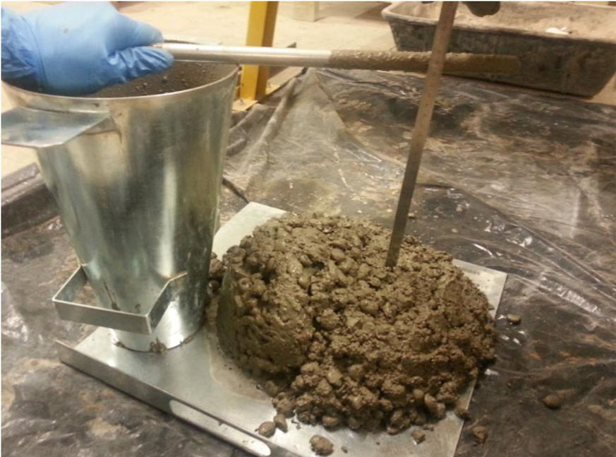
**Fig. 3.3** Slump test
