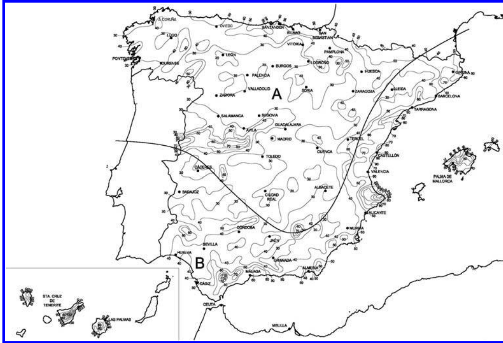
Figure 2. Maximum isoyetas map for 1 hour and T = 10 years. Source: Código Técnico de la Edificación [7].
