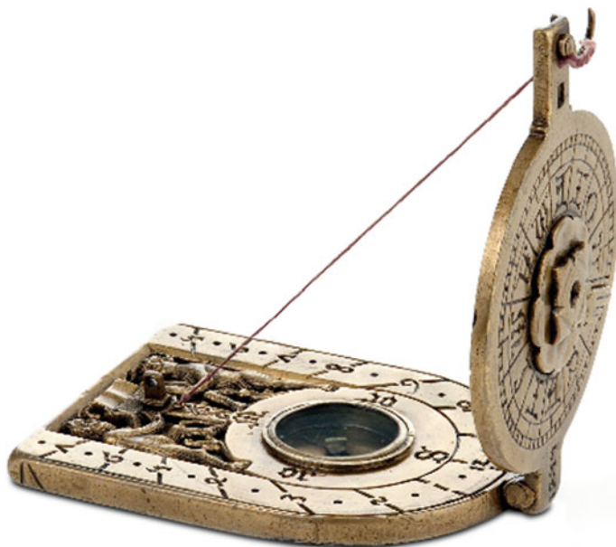
Fig. 4.14 Folding sundial ( https://www.steiermark.com/de/steiermark/ausflugsziele/museum-fuer-geschichte_p7789 )
