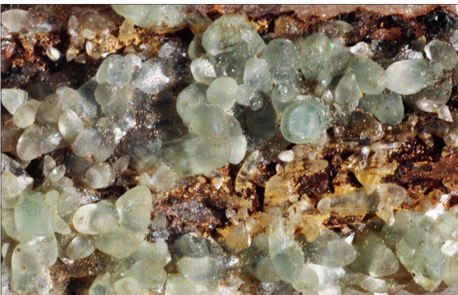
Fig. 6.47 Smithsonite (Zinc carbonate).
