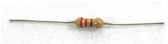
**Figure 3-5.** A  $220\Omega$  resistor
