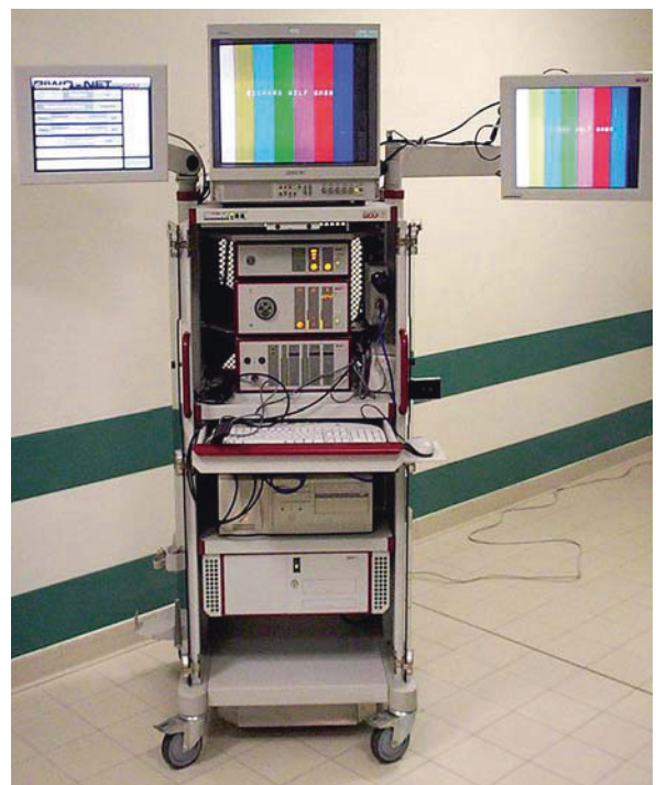
Fig. 10. Colonna video di ultima generazione che attraverso l'utilizzo di una workstation PC ci consente di archiviare le immagini e i filmati video su supporto DVD-Rom (Wolf)
