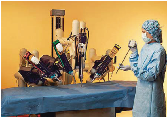
Fig.2. Il “ da Vinci ” Surgical System” (Intuitive Surgical, Inc.). Si notano i tre bracci dedicati allo strumentario e quello che sostiene la telecamera
