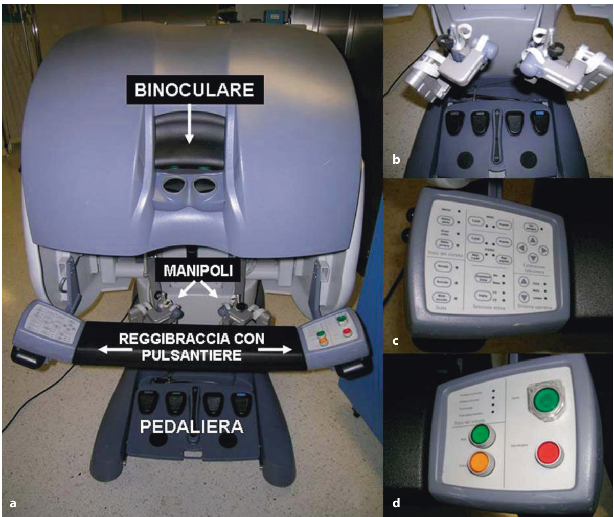
Fig. 1. La console computerizzata per il controllo del sistema chirurgico "Da Vinci" (a). Il chirurgo siede alla console, osserva il campo operatorio attraverso il binoculare 3-D e controlla gli strumenti con gli appositi manipoli (b). Le pulsantiere (c e d) sul reggibraccio consentono il controllo di varie funzioni
