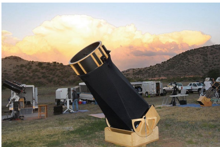
Fig. 8.8. The AstroSystems’ monster 28-inch f/3.6 Telekit (Image credit: AstroSystems).
