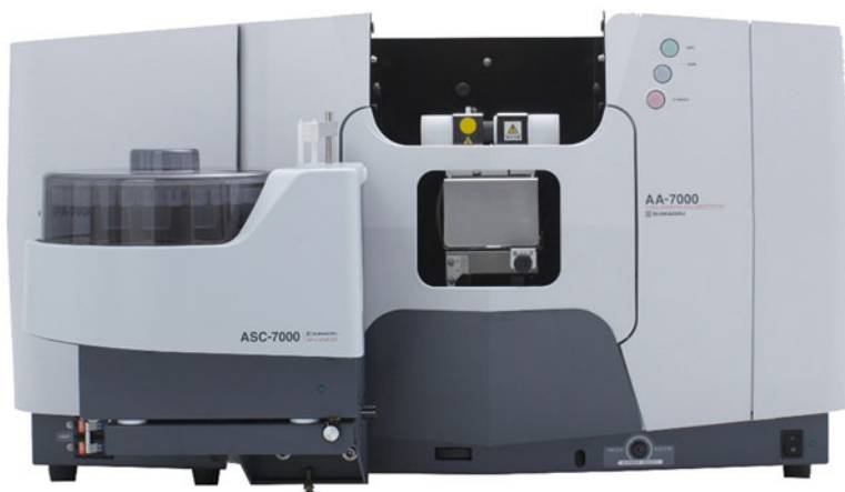
Fig. 3.11 AAS spectrometer. Courtesy of Shimadzu
