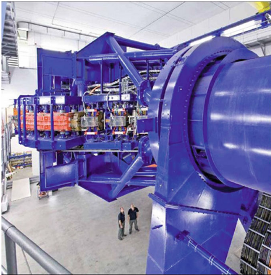
Fig. 2.13 The Heidelberg carbon-ion gantry (18 m × 7 m, 600 ton). Courtesy Thomas Haberer/Heidelberg Ion Beam Therapy Centre. Courtesy Prof. Dr. Thomas Haberer, Head of HIT and MIT
