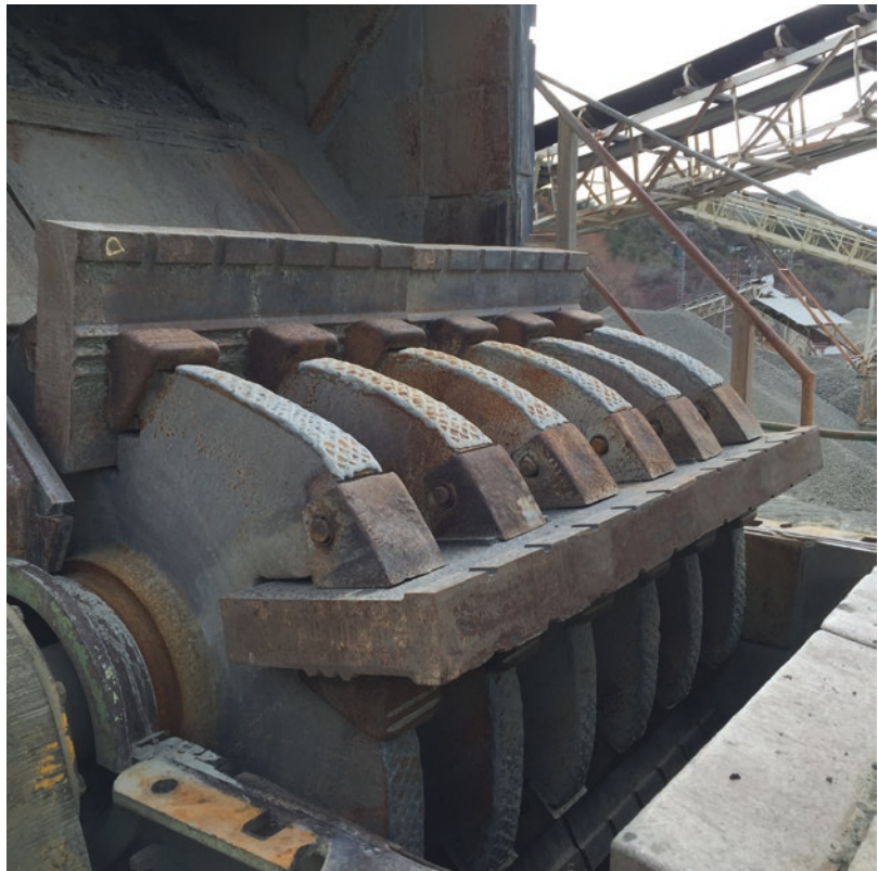
■ Fig. 6.21 Inside an impactor (Image courtesy of Benito Arnó e Hijos S.A.U.)
