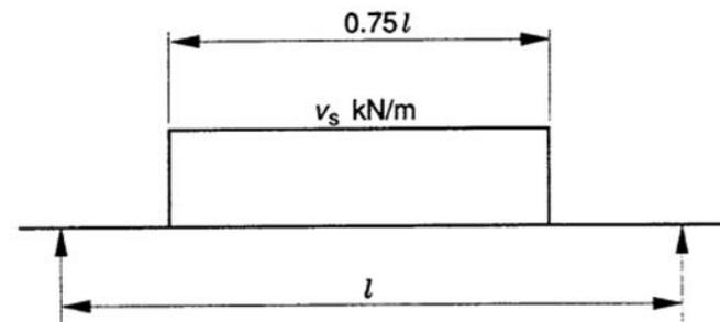
NOTE  $v_s = v_{sx}$  when  $l = l_y$ ;  $v_s = v_{sy}$  when  $l = l_x$ ;
