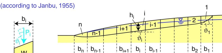
$$\frac{T_i}{\cos \vartheta_i} = \frac{(W_i + P_i - u_i \cdot b_i) \cdot \tan \varphi_i' + c' \cdot b_i}{\cos^2 \vartheta + \frac{1}{FS} \cdot \tan \vartheta_i \cdot \tan \varphi_i'}$$
